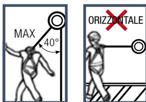
DISPOSITIVO DOTATO DI FRENATURA AUTOMATICA AD INERZIA.
