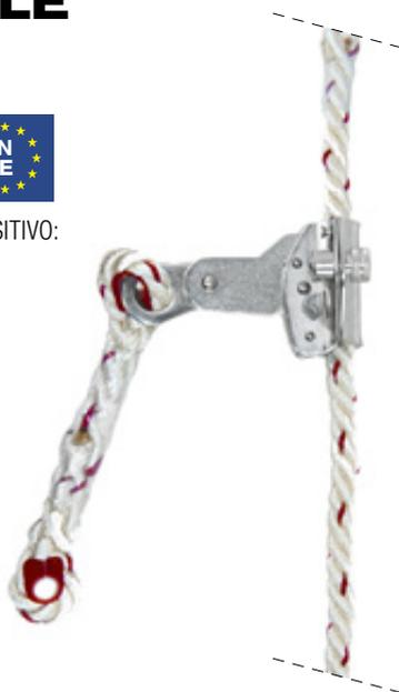
SI SPOSTA LUNGO LA PROPRIA LINEA DI ANCORAGGIO, ACCOMPAGNANDO L'UTILIZZATORE SENZA BISOGNO DEL SUO INTERVENTO MANUALE DURANTE GLI SPOSTAMENTI VERSO L'ALTO O VERSO IL BASSO E SI BLOCCA AUTOMATICAMENTE SULLA LINEA DI ANCORAGGIO IN CASO DI CADUTA PROVOCANDO LA RELATIVA DISSIPAZIONE D'ENERGIA.
