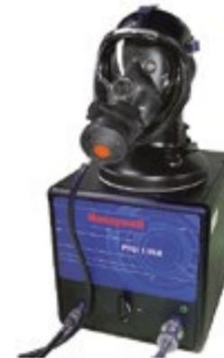
Il Posi 3 USB è un banco di prova computerizzato utilizzato per valutare le prestazioni degli autorespiratori e di altri tipi di dispositivi per la protezione delle vie respiratorie (Airline; maschere a pieno facciale).
